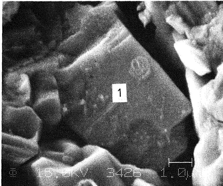
Abb. 39: Rechteckiges Korn (1) als Beispiel für eine Korngrenzenfläche (Sinterprobe der 1. Generation)
