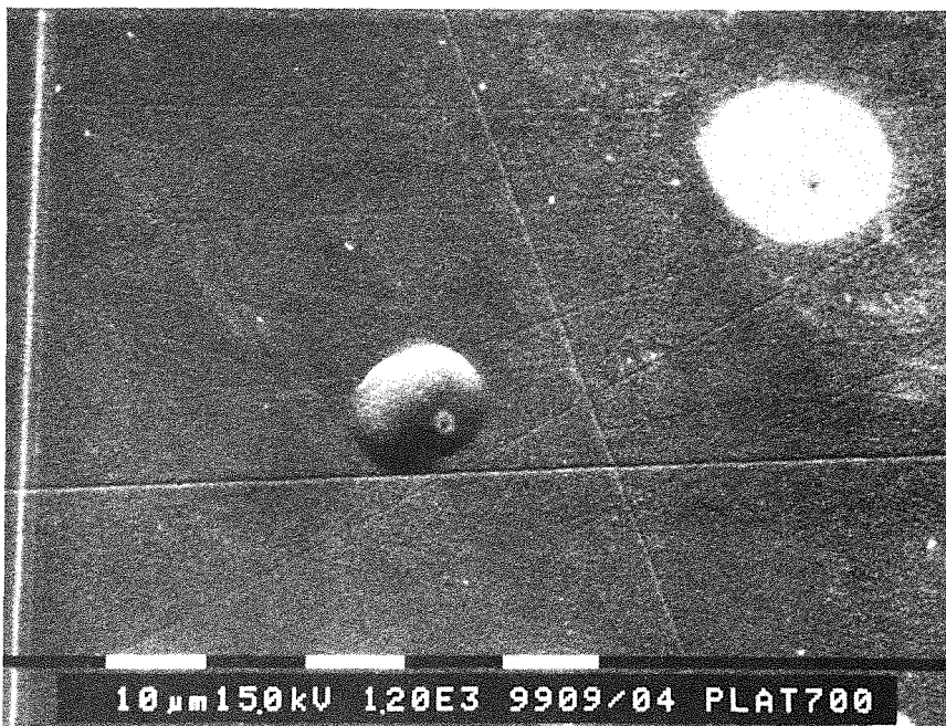
Abb. 14 Elektronenmikroskopische Aufnahme einer bestrahlten Platin-Schicht. Die Oberfläche weist bis auf Erhebungen durch Ar-Blasen und Vertiefungen durch geplatzte Ar-Blasen keine Unebenheiten auf. Dies läßt darauf schließen, daß die Platin-Schicht bei der Ar ++ -Bestrahlung nicht selektiv abgesputtert wird. Kristallite verschiedener Orientierungen werden gleichmäßig abgetragen. Die Textur ändert sich durch lokales Aufschmelzen und anschließende Rekristallisation mit neuer Orientierung.
