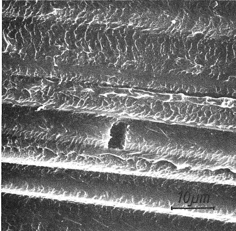
**Abb. 11:** REM-Aufnahme des Bruchbildes von AS4/PEEK (1850-fache Vergrößerung) Längsriß und einzelne gebrochene Faser.
