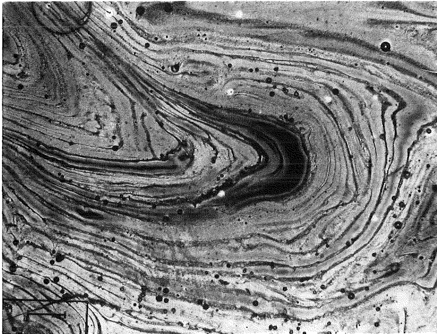
Abb. 2: Schlieriges, durch die Verbrennung neu gebildetes Glas. Schlacke A, DII, cm - 0,4 mm
