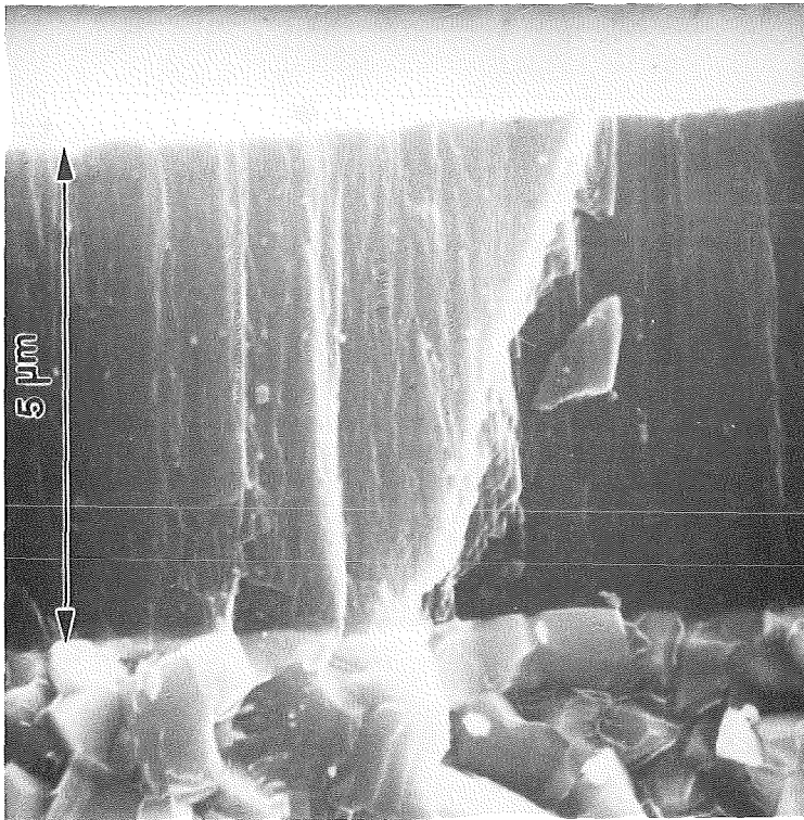
Abb.:35 Bruchflächen einer TiN/SiC 80:20 Schicht abgeschieden mit und ohne Ionenbeschuß; oben 0V, unten 400V Biasspannung.
