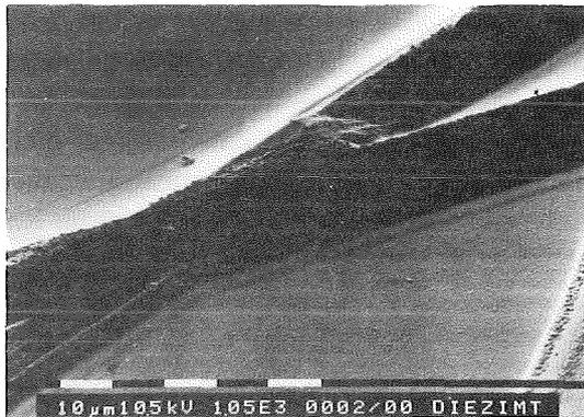
Abb. 6. a) Abformung zweier 15 µm dicker Wolframdrähte in einem Naturdiamanten. b) Die Abformung des Kreuzungspunktes der beiden Drähte in vergrößerter Darstellung.
