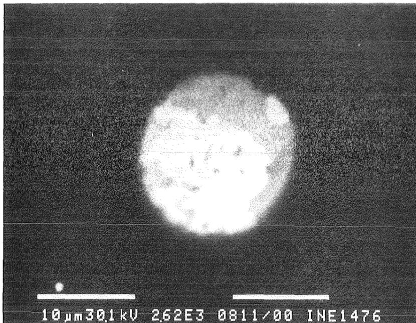
Abbildung 214: Metallische Partikel im HAWC-Glas, REM-Aufnahme
