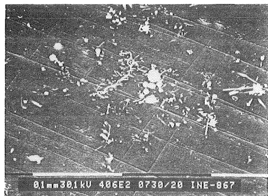
Abbildung 68: Verteilung der Platinmetallpartikel in Kokille K 75/87 (Probenort entsprechend Abb. 65)
