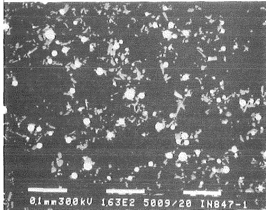
Abbildung 74: Verteilung der Platinmetalle im Schmelztiegel (Probenort entsprechend Abb. 72; Zone 3)
