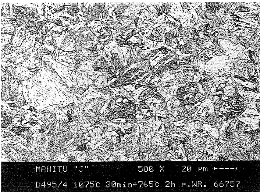
K-Charge, parallel zur Walzrichtung, 500-fache Vergrößerung
