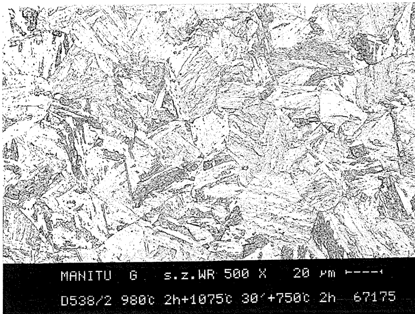
MANET-I, senkrecht zur Walzrichtung, 500-fache Vergrößerung
