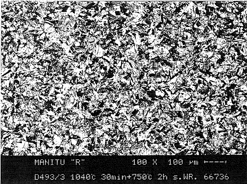
F82H, senkrecht zur Walzrichtung, 100-fache Vergrößerung
