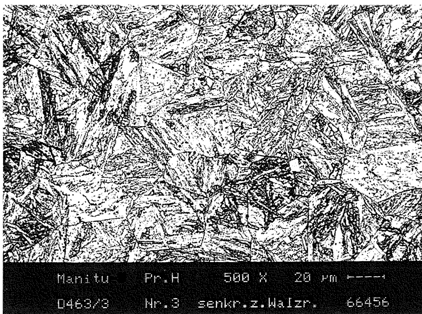
MANET-II, senkrecht zur Walzrichtung, 500-fache Vergrößerung
