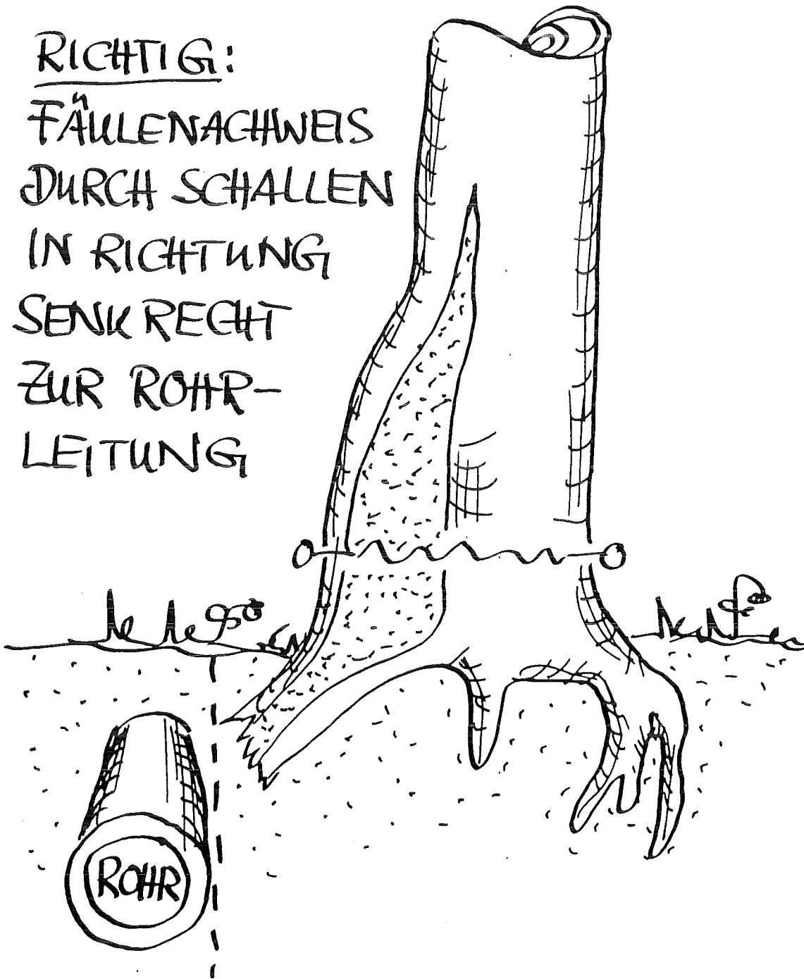
Abb.3: Fauler Stammfuß nach Wurzelschaden infolge Schachtung.
