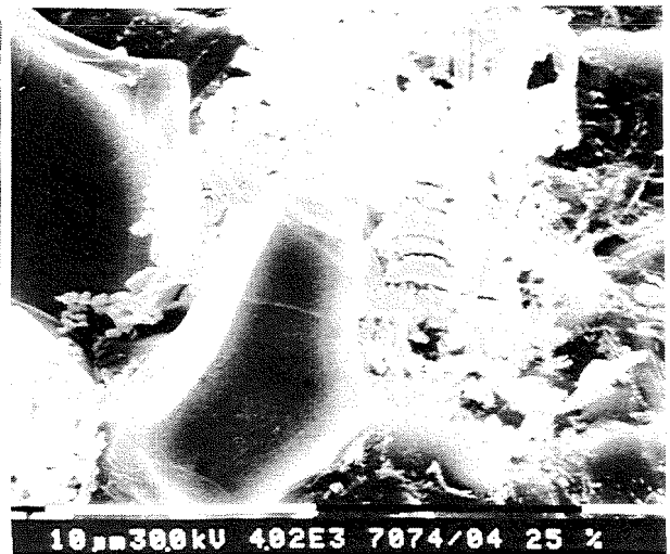
Abb. 8: M_{23}C_6 -Ausscheidungen als „Wände“ um den Deltaferrit
