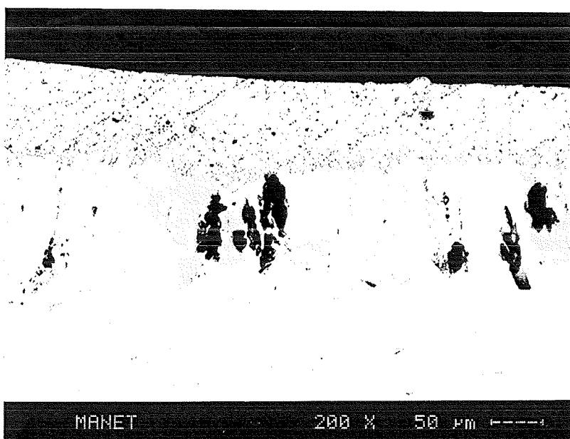
Abb. 33: Schmelze 5 (1 Gew.% W), 10 Minuten Tauchzeit bei 800 °C
