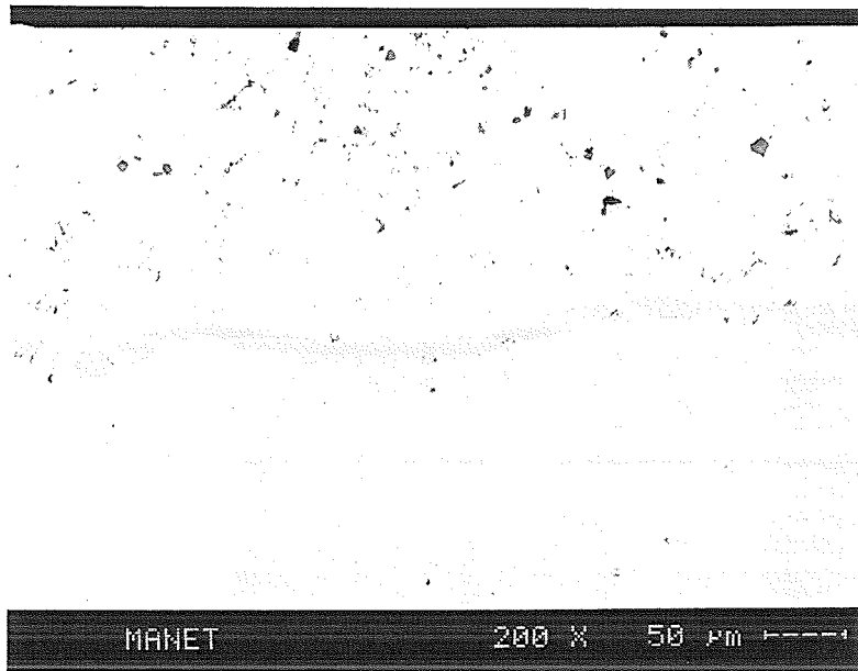
Abb. 44: Schmelze 8 (0,5 Gew.% V), 1 Minute Tauchzeit bei 800 °C
