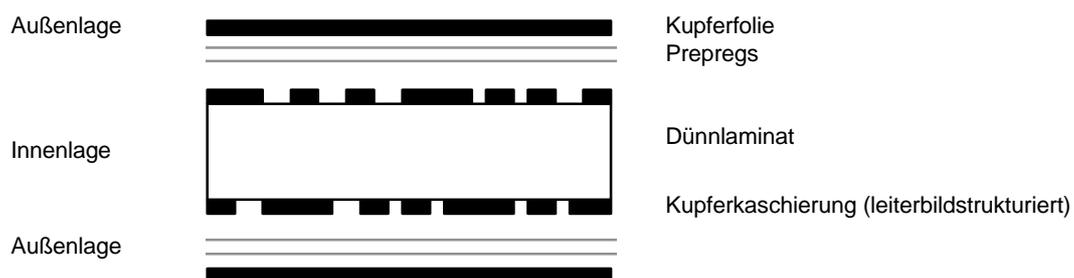
**Abbildung 9:** Aufbau eines 4-Lagen-Multilayers (vier Schaltungsebenen).
