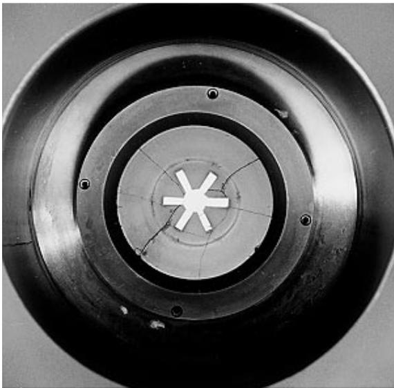
Abb.5: Planarmagnetron mit NAS-Grundtarget und Fe-Folie, die im Targetzentrum durch den Kathodenmagneten fixiert ist
