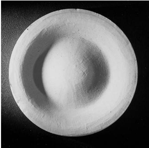
Abb.2: SnO<sub>2</sub>-Target nach ca. 120 h Sputterzeit mit deutlich sichtbarer Haupterosionszone
