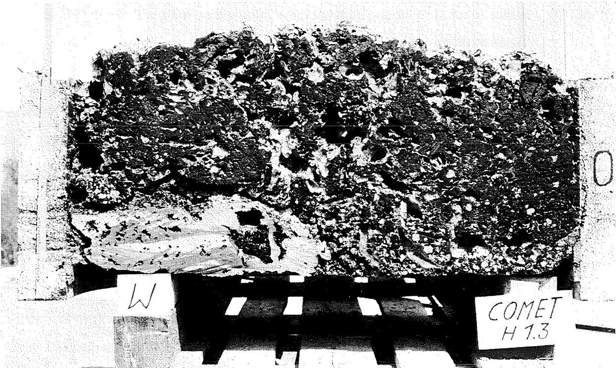
Abb. 12: Querschnitt der porös erstarrten Schmelze in COMET-H 1.3
