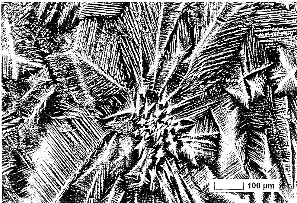
Abb.47: Scheinbar mit Melilith vollständig kristallisiertes Präparat nach 1h bei 1000°C.
