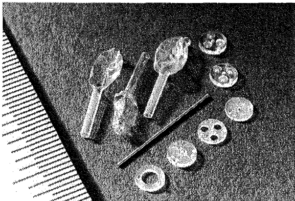
Abb. 2: Einzelteile des Positioniersystems: Mikrostrukturierte Plexiglasplättchen, Ballons aus Polyurethan sowie eine Edelstahlkanüle
