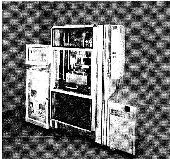
Abb. 1: Mit der von JENOPTIK Mikrotechnik und IMT gemeinsam entwickelten Heißprägemaschine HEX03eT kann auf vorstrukturierten Substraten positioniert abgeformt werden.
