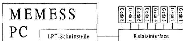
Abbildung 9 - Anschluß eines Relaisinterface.
