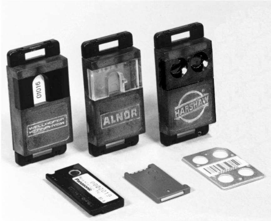
Abb. 2 Albedodosimeter und die zugehörigen Detektorkarten, von links nach rechts Typ Panasonic, Alnor und Harshaw
