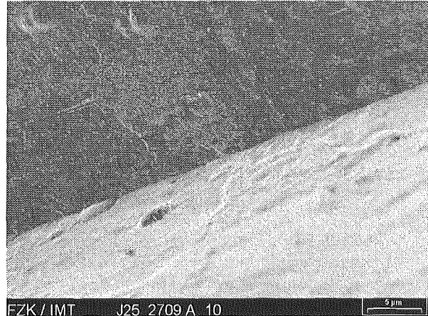
Abb. 4: Detail einer Strukturkante in Stahl 1.2709, entgratet durch Elektropolieren. Man beachte die geringe Kantenverrundung!
