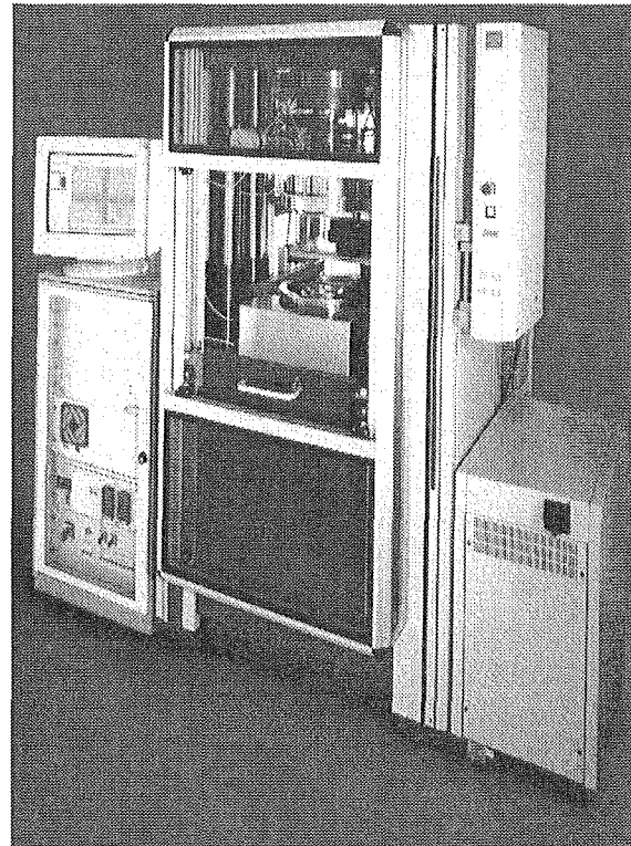
Abb. 5: Heißprägeanlage HEX 03 mit integriertem Überdeckungssystem zum positionierten Prägen auf vorstrukturierten Substraten.
