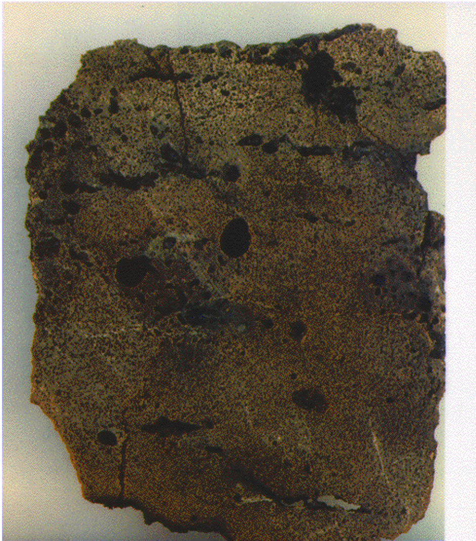
Abb. 4.6: Oxidkruste im hinteren, gefluteten Bereich
