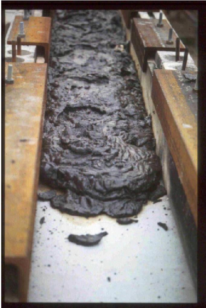
**Abb. 3.5.8:** Photographie des Endstückes der ausgebreiteten Oxidschmelze
