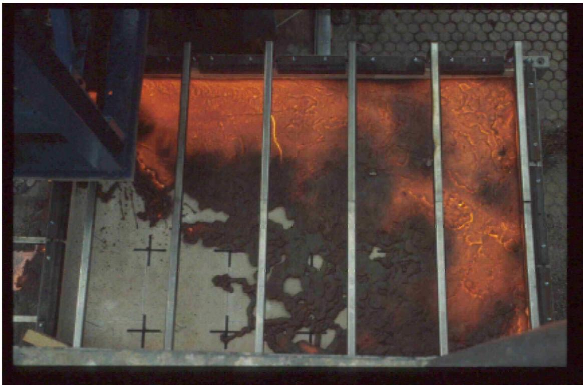
**Abb. 3.1.7:** Ausgebreitete Oxidschmelze in KATS-8 kurz nach Ende der Ausbreitung
