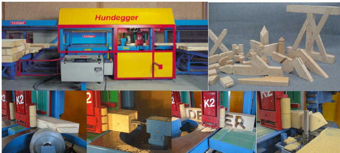
Abb. 3.17: Beispiel einer Abbundanlage, Profile und Fertigungsschritte (Quelle: Fa. Hundegger)
