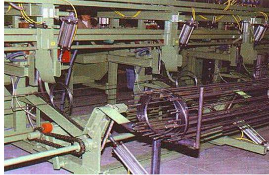
Abb. 3.19: Schweißbox für Bewehrungsmatten (Quelle: Fa. BAMTEC-Süd)
