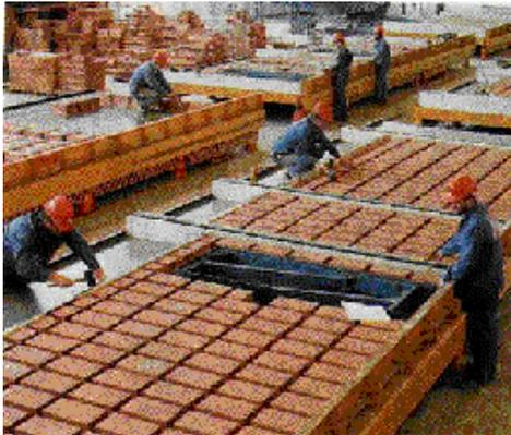
Abb. 3.14: Liegende Fertigung von Mauerwerkselementen (Quelle Fa. Winkelmann)
