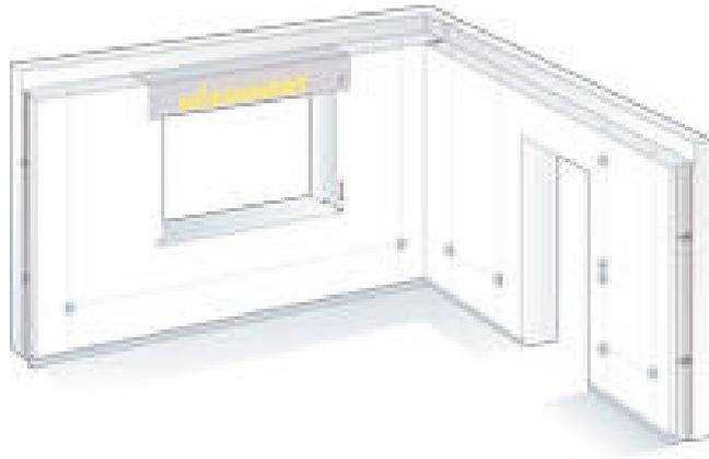
Abb. 3.11: Wandelemente bei der Tafelbauweise (Quelle: Dennert KG)
