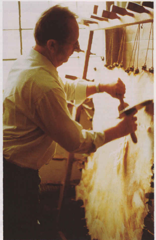
Abb. 7: Schaben der gespannten Haut
