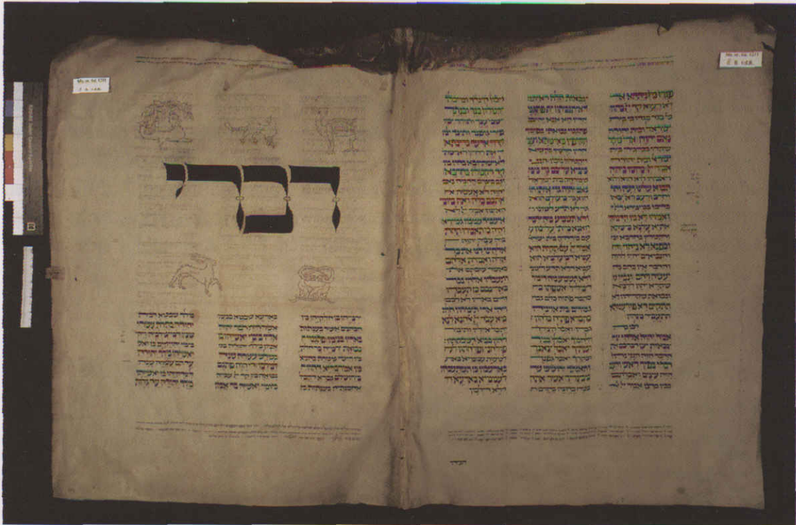
Abb. 40: Doppelblatt 1A/ 8B vor der Restaurierung; deutlich erkennbar sind die starken Verspannungen im Falzbereich und am Kopf sowie die durch Gelatinierung entstandenen Fehlstellen (Reproduktion mit Genehmigung der Orientabteilung der Staatsbibliothek zu Berlin – Preußischer Kulturbesitz)
