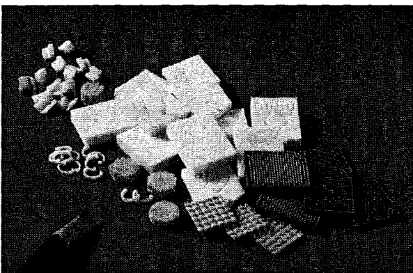
Abb. 15: Keramische Mikrobauteile hergestellt über die Rapid Prototyping Prozesskette.
