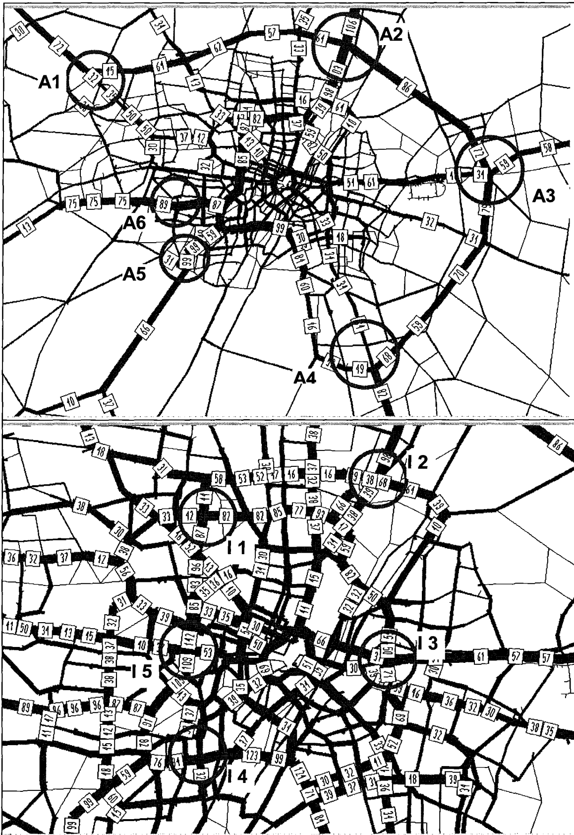
Abb. 25: Errechnete Belastung an einem mittleren Werktag im äußeren Bereich Münchens (oben) und im Bereich der Münchener Innenstadt (unten) – Referenzfall (Querschnittswerte in 1000 Kfz/24 h, benannt sind nur Werte \geq 30000 Kfz/24 h)
