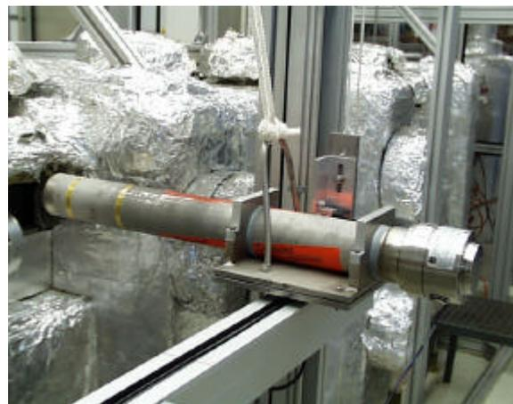
Abbildung 4.6: Foto des Szintillationsdetektors.
