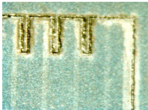
Abb. D.9: Chrom-Schicht auf Titan-Struktur (Sensor 079);
