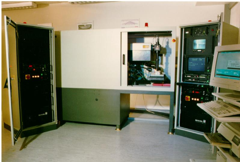
Abb. 3.3: Bearbeitungsanlage für das Laserstrahlschneiden und den Laserstrahlformabtrag mit Nd:YAG-Laserstrahlung am FZK/IMF I (Wellenlänge 1064 nm, Pulsbreite beim Schneiden: 0,1 - 0,2 ms, Pulsbreite beim Formabtrag 100 - 200 ns).
