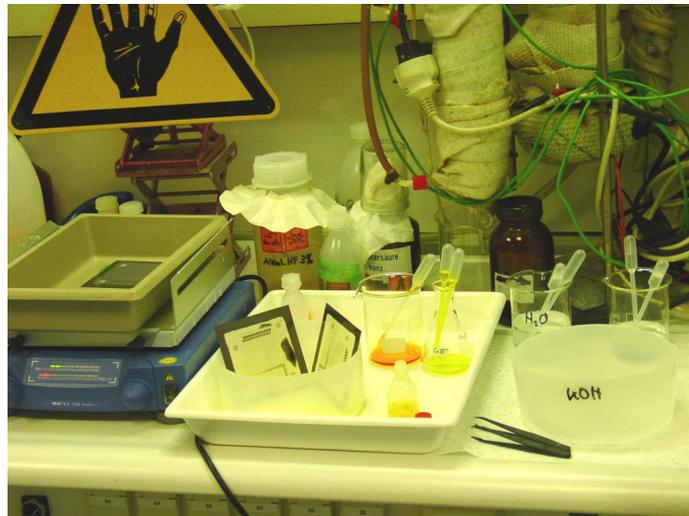
Abb. 3.11: Einrichtung Ätzplatz (zum Zeitpunkt einer Cr-Ätzung durch gelborange Ce(IV)-Lösung) am FZK/IMF III.
