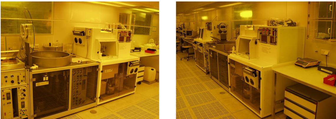
Abb. 3.10: Spincoater und Sprühtwickler im Reinraum des FZK/IMT.
