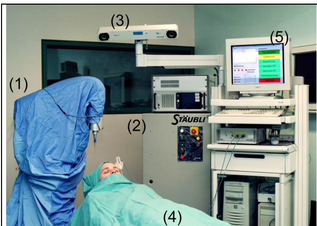
Abb. 1: Das System RobaCKa ist aus den Komponenten (1) Staubli RX90 Roboter, (2) Robotersteuerung, (3) Navigationsystem und (5) Windows-Steuerrechner (RT-Linux basiert) aufgebaut. Auch der Patient (4) wird mit einem Rigid-Body ausgestattet und während des gesamten Eingriffes getrackt.
