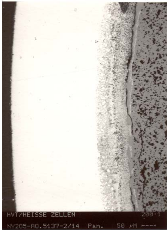
Abb. III.5.1+ Hüllkorrosion bei einem Brennelement des KNK II-Reaktors nach einem Abb. III.5.2 Abbrand von 18,6 at.%
