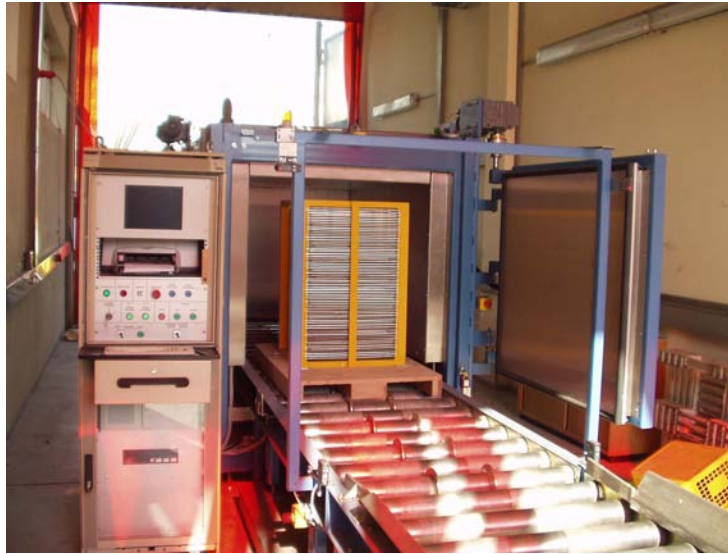
Abb. 4-11: Gesamtansicht der Freimessanlage mit dem Kalibrierdummy „R-200-Fass“
