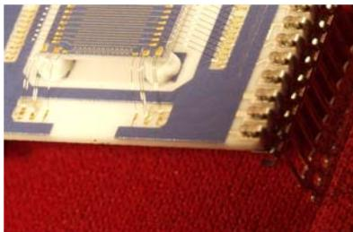
Abb. 166: Prototyp einer Trägerplatte mit aufgeklebtem und Draht-gebondetem Chip (Entwicklungsstufe) sowie angelöteten Steckkontakten.
