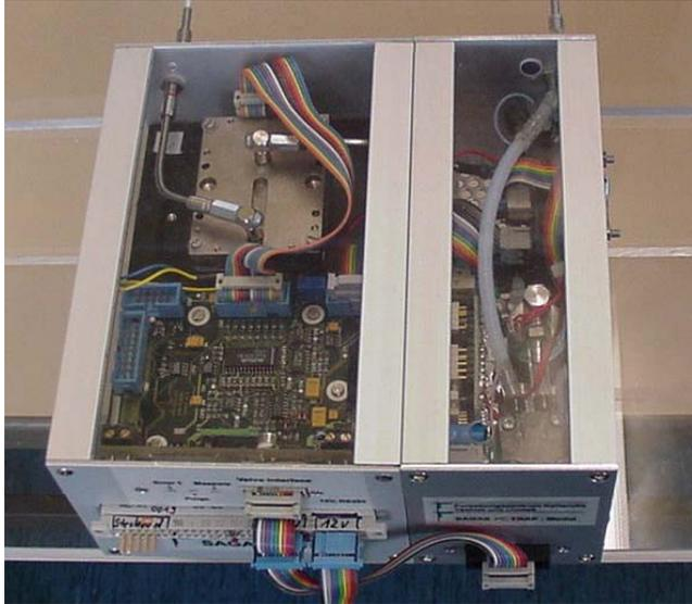
Abb. 29: Kompaktes SAW-System mit Mikroarray (links) und Voranreicherungseinheit (rechts).
