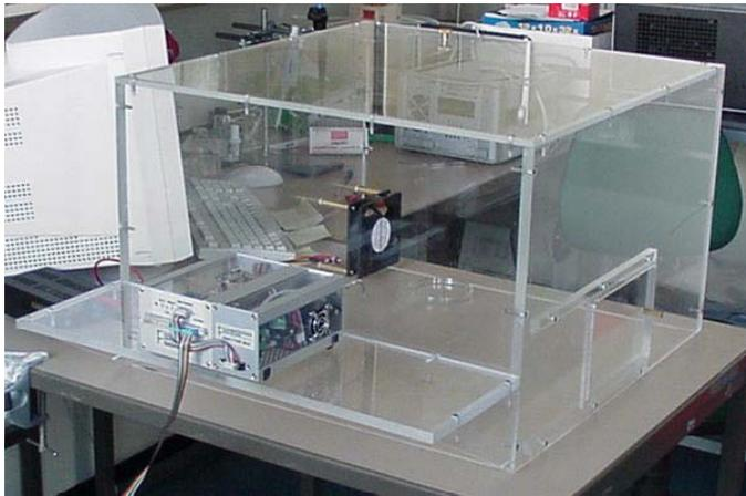
Abb. 30: Rezipient für genaue Raumluft-Kontaminationsmessungen.
