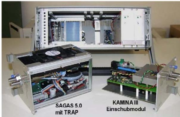
Abb. 177: SAGAS 5.0 und KAMINA III als Einschubkomponenten für ein 19“ Gehäuse.
