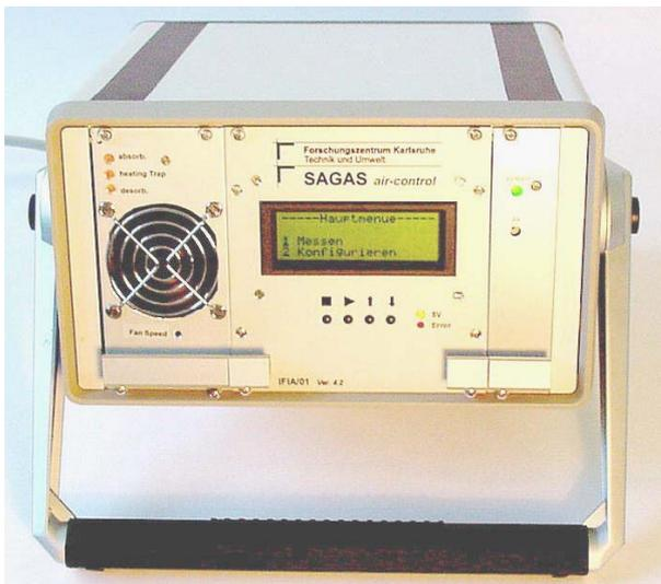
Abb. 28: Labormuster mit SAW-Mikroarray zur Überwachung von Außenluft-Alarmsituationen.
