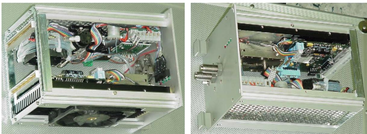
Abb. 100: 19", 3HE, 28TE SAWMA-Einschub mit TRAP (Ansichten von schräg vorne und hinten).
