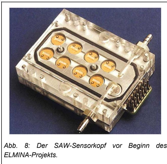
Abb. 8: Der SAW-Sensorkopf vor Beginn des ELMINA-Projekts.
