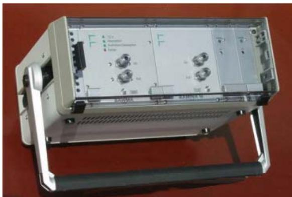
Abb. 176: SAMONA-System mit SAGAS 5.0-Einschub links, KAMINA III in der Mitte und den Versorgungseinheiten rechts
