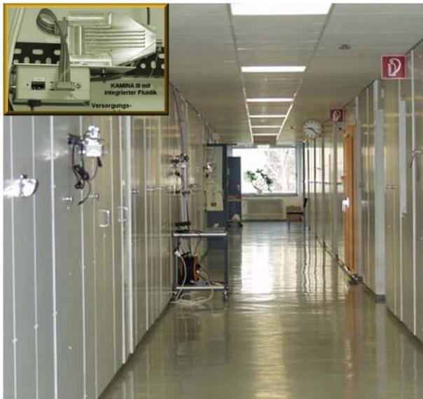
Abb. 158: Netzwerk zur Raumluftüberwachung im IFIA. Fünf KAMINA III werden zur Ermittlung der zeitlich-räumlichen Ausbreitungseigenschaften von definierten Ereignissen eingesetzt.
