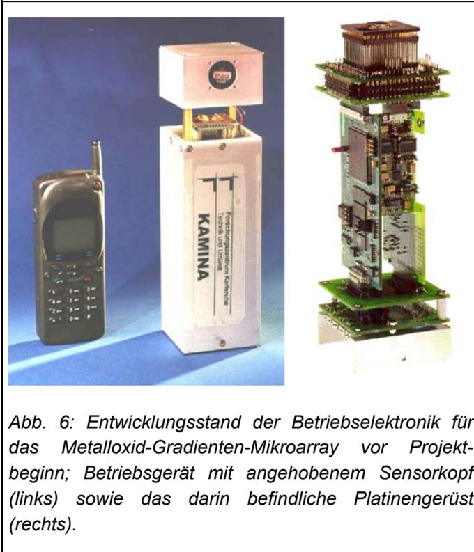
In Abb. 6 ist der Entwicklungsstand der **Betriebselektronik** für das Metalloxid-Gradienten-Mikroarray vor Projektbeginn dargestellt. Hier bestanden die Ziele des ELMINA-Projekts darin, den Platzbedarf der Betriebselektronik zu verkleinern und gleichzeitig deren Herstellung kostengünstiger zu gestalten.
