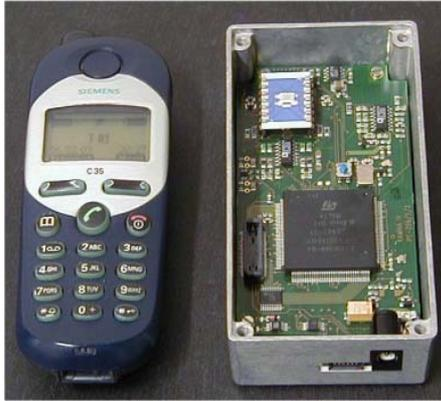
Abb. 163: KAMINA IV im Gehäuse mit Steckverbindern an der Stirnseite, jedoch noch ohne Fluidik
