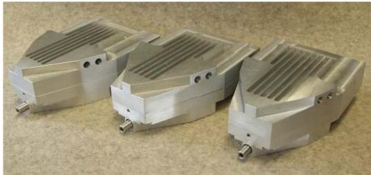
Abb. 161: KAMINA III im Gehäuse; sichtbar sind der Gaseinlass vorne an der Spitze sowie die eingearbeiteten Kühlrippen auf der Oberseite
