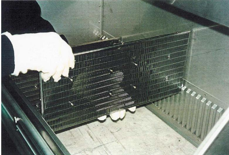
Kassette (Aluminiumoxidkugeln als Träger, Katalysator Palladium, zum Schutz gegen Nässe (Hydrophobierung): wasserabscheidende Schicht)
