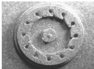
Abb. 8: Gegossene Turbinendüsenplatte aus Al-Bronze, Durchmesser 4 mm, Kanalbreite 25 \mu\text{m} .
