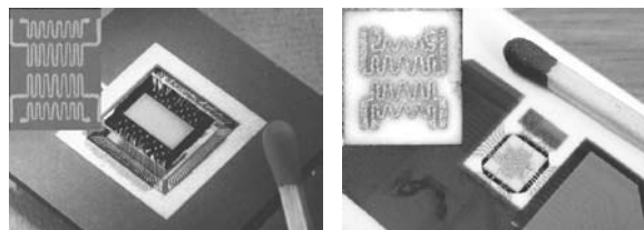
Abb. 1: Auf PGA-Gehäuse montierter KAMINA-Chip mit 38 Sensorsegmenten auf Si-Substrat (links) sowie in einer Keramikträgerkarte an Golddrähten aufgehängter KAMINA-Chip mit 16 Sensorsegmenten auf \text{Al}_2\text{O}_3 -Substrat (rechts). Auf der Rückseite (jeweils links oben) befinden sich vier Heizmäander zur kontrolliert inhomogenen Beheizung des Mikroarrays.
