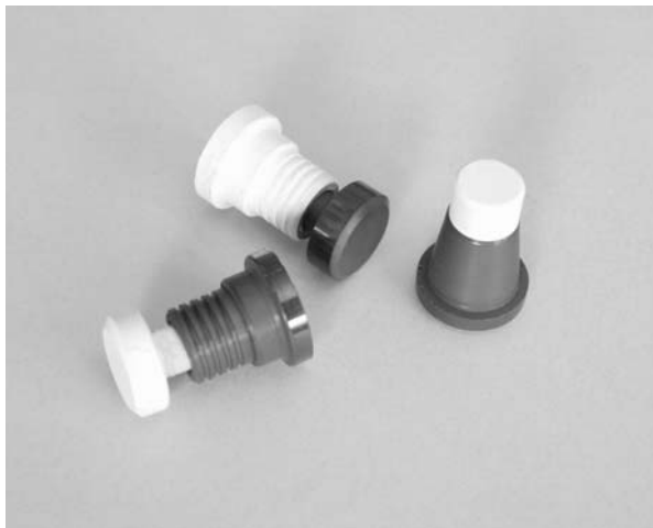
Abb.1: Spanabhebend gefertigte Grünkörper und daraus schwindungsfrei gesinterte Mikroteile
