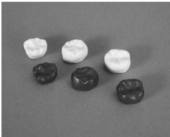
Abb. 6: Gefräste, passgenaue Dentalkronen vor und nach dem Reaktionssintern.
