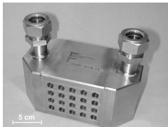
Abb. Nr. 1: Elektrisch beheizter (20 kW) Mikrowärmeübertrager für einen Durchsatz von 1000 kg/h Biodiesel. Die Bohrungen dienen der Aufnahme von Heizpatronen.
