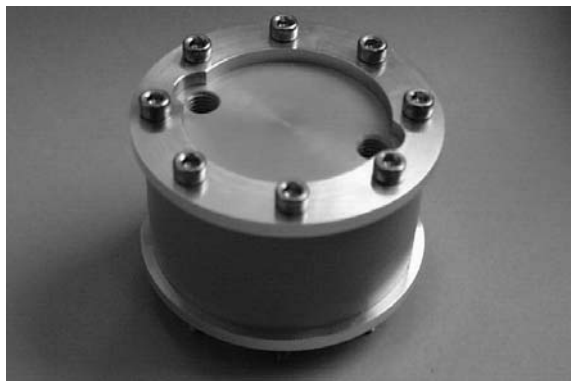
Abb. 10: Erster Demonstrator eines funktionstüchtigen Mikroentgasers
