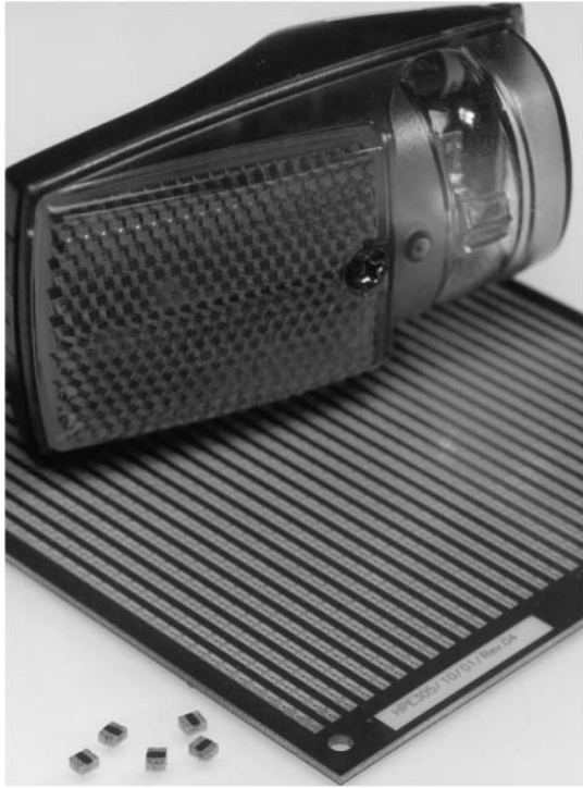
Bild 3: mehr als 1000 Schalter werden gleichzeitig im Mehrfachnutzen hergestellt.
