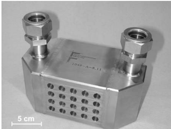
Abb. 9: Elektrisch beheizter Mikrowärmeübertrager mit einer Anschlußleistung von 20 kW, geeignet für einen Durchsatz von 1000 \text{ kg} \cdot \text{h}^{-1} Biodiesel.
