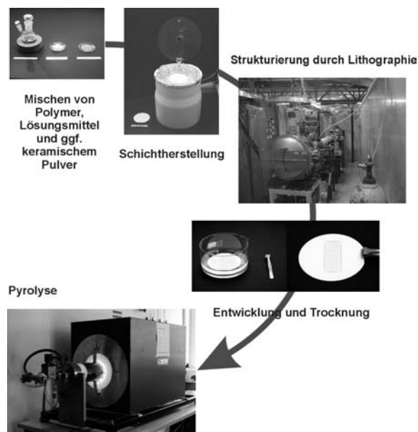
Abb. 3: Ablauf des Verfahrens zur Mikrostrukturierung präkeramischer Polymere mit Hilfe der Röntgentiefenlithographie
