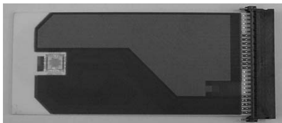
Abb. 2: GSMA in Sievert-Träger
