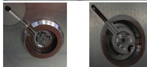
Abb. 2: Spritzgießwerkzeug der Fa. Junghans Feinwerktechnik für Keramik-Ferrulen: Düsen-seite (o.), Kavität Düsen-seite (u. l.), Kavität Auswerferseite (u. r.).
