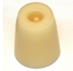
Zahnblende aus Aluminiumoxid als Teil eines Implantats in der Dentaltechnik \text{Øa} = 6,5 \text{ mm}
