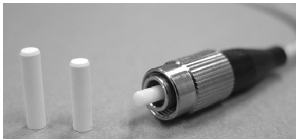
Abb. 1 Zirkonoxid-Ferrulen: von links: Grünling, gesintertes Teil und Glasfaserstecker Typ FC/PC
