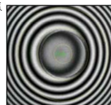
Kontrolle der Stirnfläche (Polversatz)
