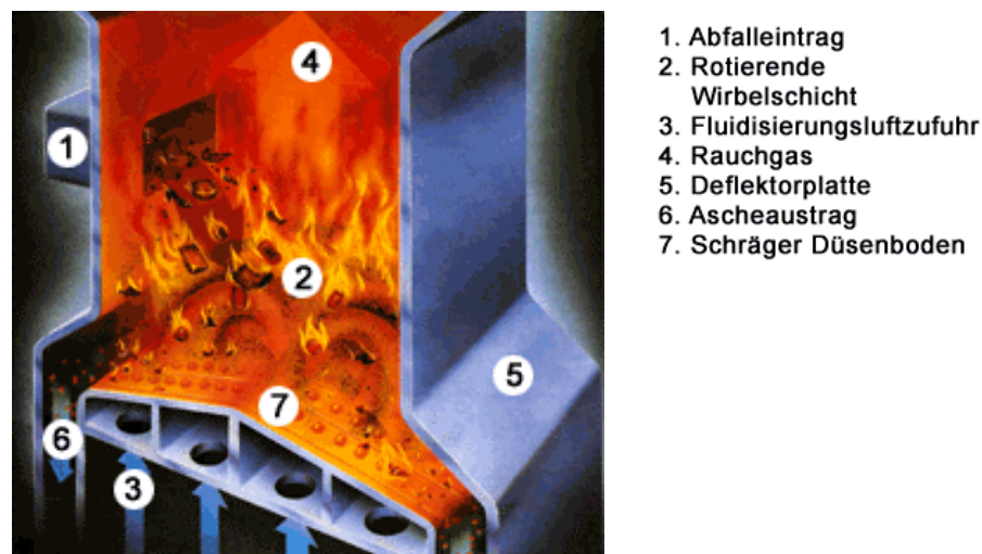
Abbildung 9: Schema der ROWITEC-/ TIF-Feuerung [LEE]
