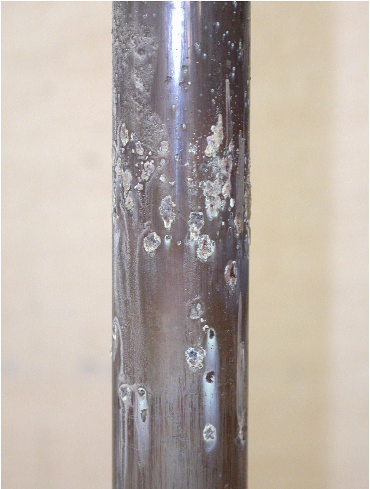
Abb. 9 Ablagerungen und Korrosion auf dem Ringraumwärmetauscher
