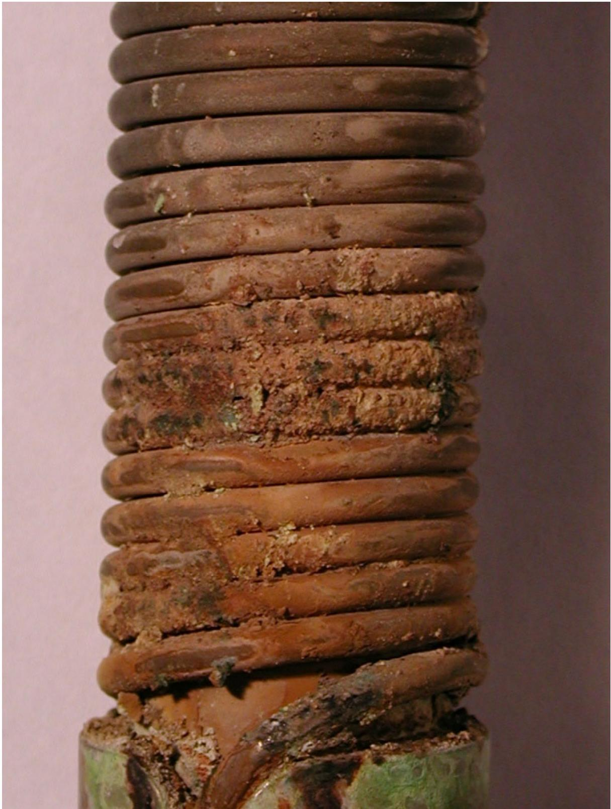
Abb. 7 Ablagerungen und Korrosion auf dem Rohrwendelwärmetauscher
