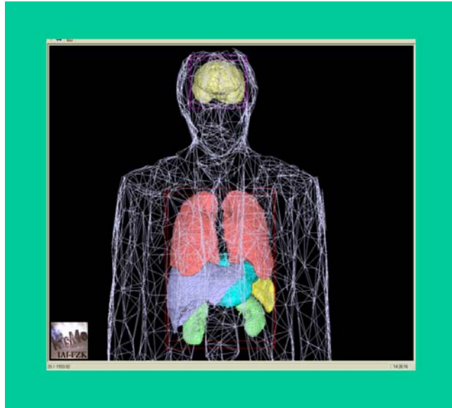
Abb. 4-19: Implementierung einiger Organe des Voxel-Phantom MEET Man vom IBT in den Laserscan (als „wireframe“ dargestellt) eines Mitarbeiters von HS/ÜM.
