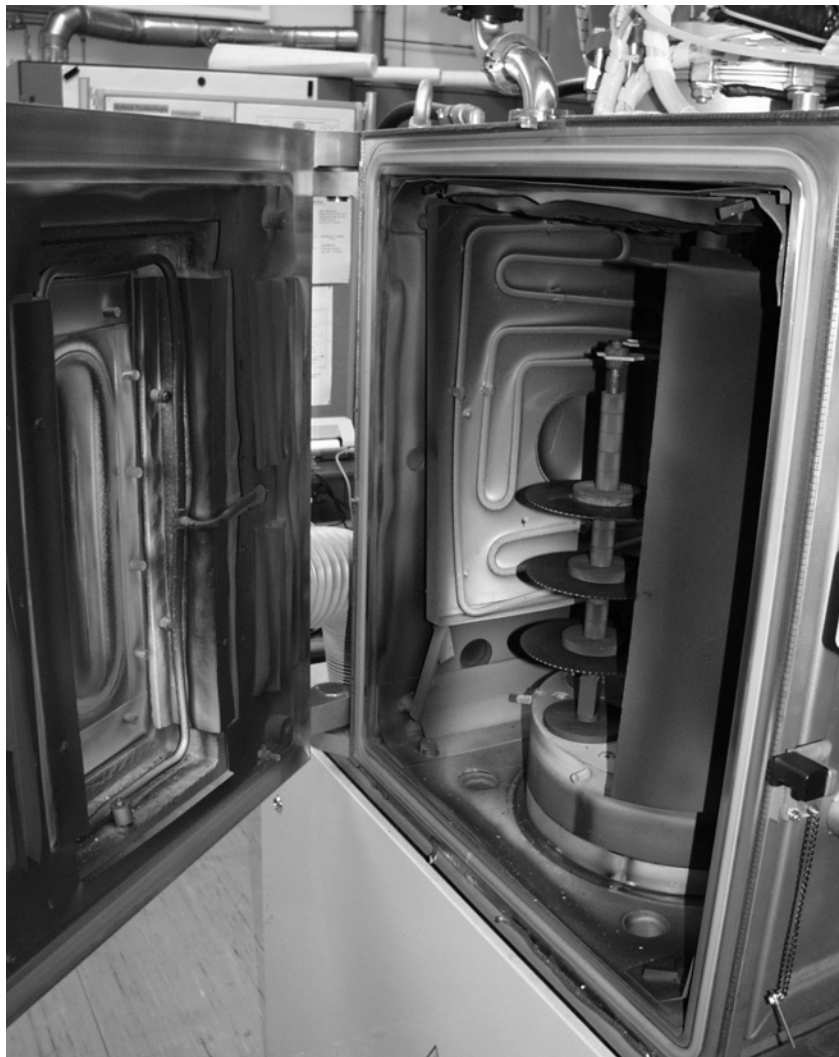
Abb. 1: Magnetronzerstäubungsanlage mit zu beschichtenden Sägeblättern auf dem Substrathalter.
