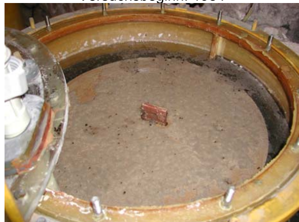
d) #35, NaCl-Lösung, W/Z = 0.50 Versuchsbeginn: 1989
