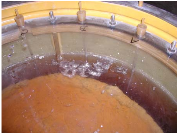
a) #25, Q-Lösung, W/Z = 0.30 Versuchsbeginn: 1984
