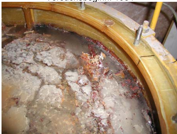
c) #34, Q-Lösung, W/Z = 0.50 Versuchsbeginn: 1980
