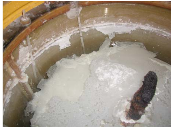
b) #27, NaCl-Lösung, W/Z = 0.43 Versuchsbeginn: 1984
