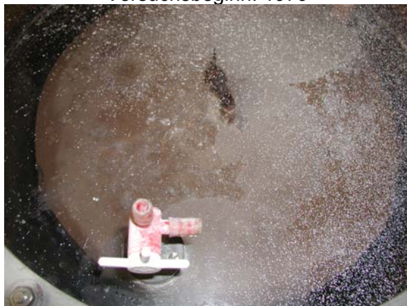
c) #31, NaCl-Lösung, W/Z = 0.50 Versuchsbeginn: 1988
