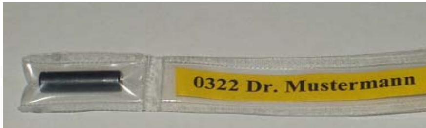
Abb. 4-12: Sondenkapsel GD-354M in einer hitzebeständigen Kunststoffhülle zum Einsatz als Teilkörperdosimeter
