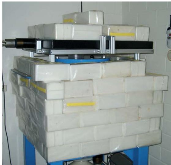
Abb. 4-29: Messanordnung mit Paraffinblöcken
