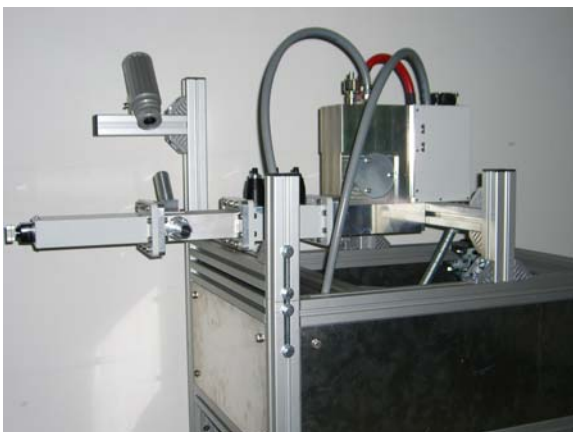
Mikrowellenanlage zur Integration in ein FTIR Spektrometer.
