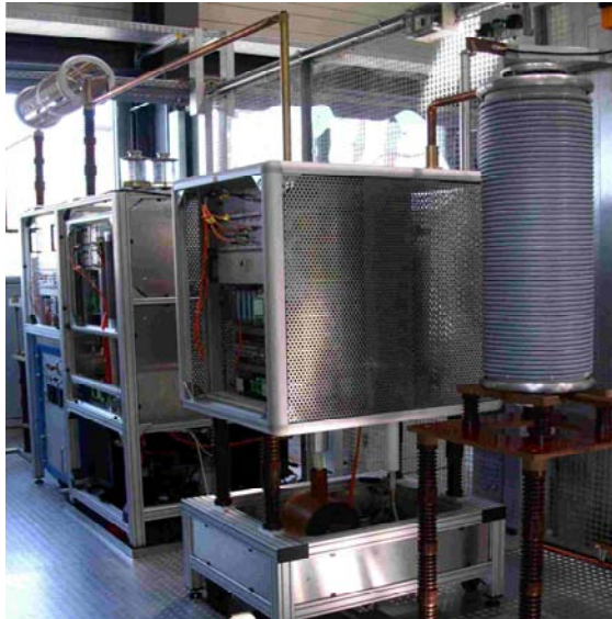
Hochspannungskontrollsystem für die Gyrotrons. Es besteht aus dem Modulator für die Bodyspannung ( „Single-stage depression voltage zur Energierückgewinnung ), der Kathodenheizung und der Thyatron-Schutteinheit. Links: Hochspannungskontrollsystem der W7-X Gyrotrons (von links: Modulator, Crowbar und Zündungsspule). Rechts: Einzelheiten des Modulators: Röhrengehäuse mit Kühlschläuchen und HV-Isolatoren.
