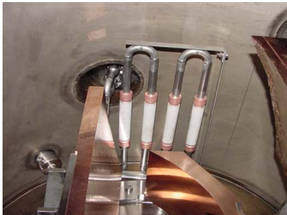
Blick in die Spiegelbox des Gyrotrons mit der Anordnung der Testabsorber.
