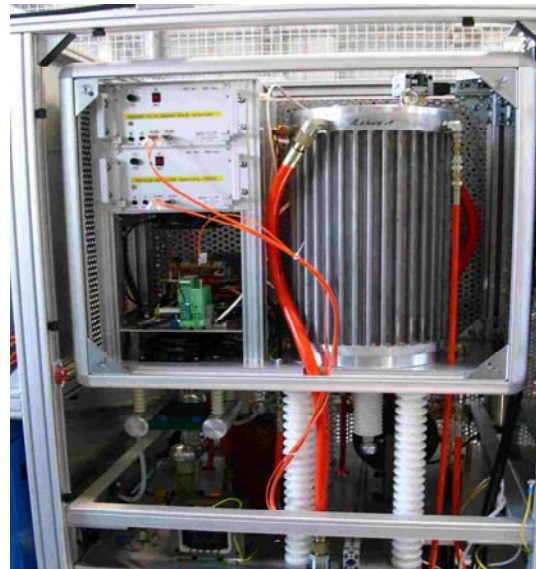
Hochspannungskontrollsystem für die Gyrotrons. Es besteht aus dem Modulator für die Bodyspannung ( „Single-stage depression voltage zur Energierückgewinnung ), der Kathodenheizung und der Thyatron-Schutteinheit. Links: Hochspannungskontrollsystem der W7-X Gyrotrons (von links: Modulator, Crowbar und Zündungsspule). Rechts: Einzelheiten des Modulators: Röhrengehäuse mit Kühlschläuchen und HV-Isolatoren.
