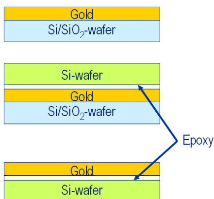
Abb. 54: Prozessabfolge des TSG-Verfahrens
