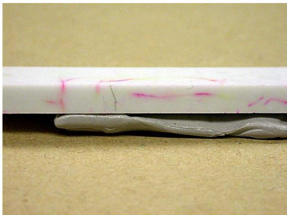
**Bild 18**  $\text{Al}_2\text{O}_3$ - Keramik mit Rissen, hergestellt aus Rohstoff B.
