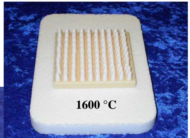
**B - SG - W** (Feedstock aus B, Spritzgießen, Binder W)
