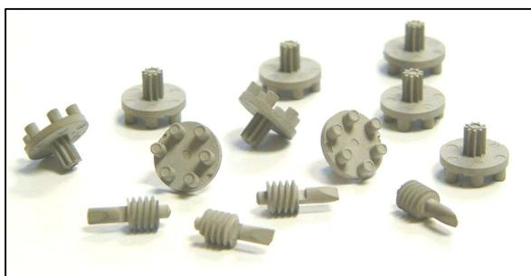
**Abbildung 10:** Gesinterte Demonstrator-Bauteile aus korrosionsbeständigem und härtbarem Stahl 17-4PH: vorn Getriebeschnecke, dahinter Planetenträger.
