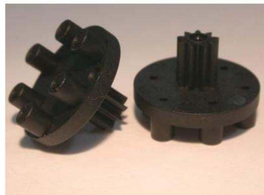
Anforderungen an den Planetenträger für Mikromotoren:
