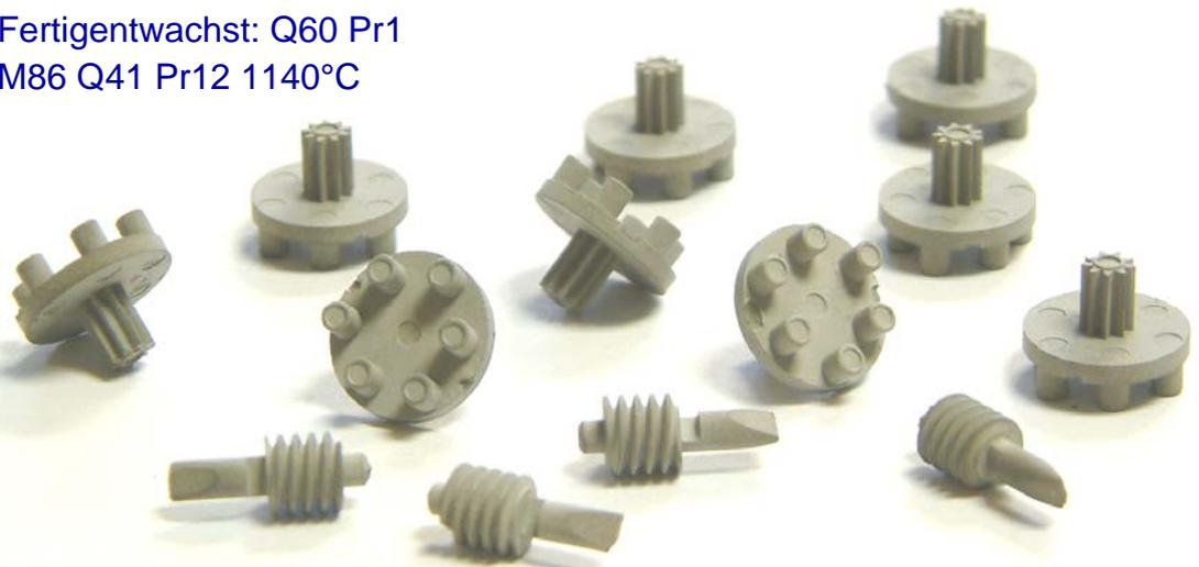
PIM mit feinem Stahlpulver ermöglicht das Sintern bei geringerer Temperatur
