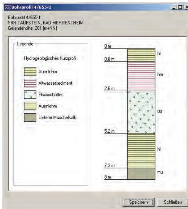
Abbildung 3: Visualisierung von Schicht- und Ausbauprofilen nach DIN
