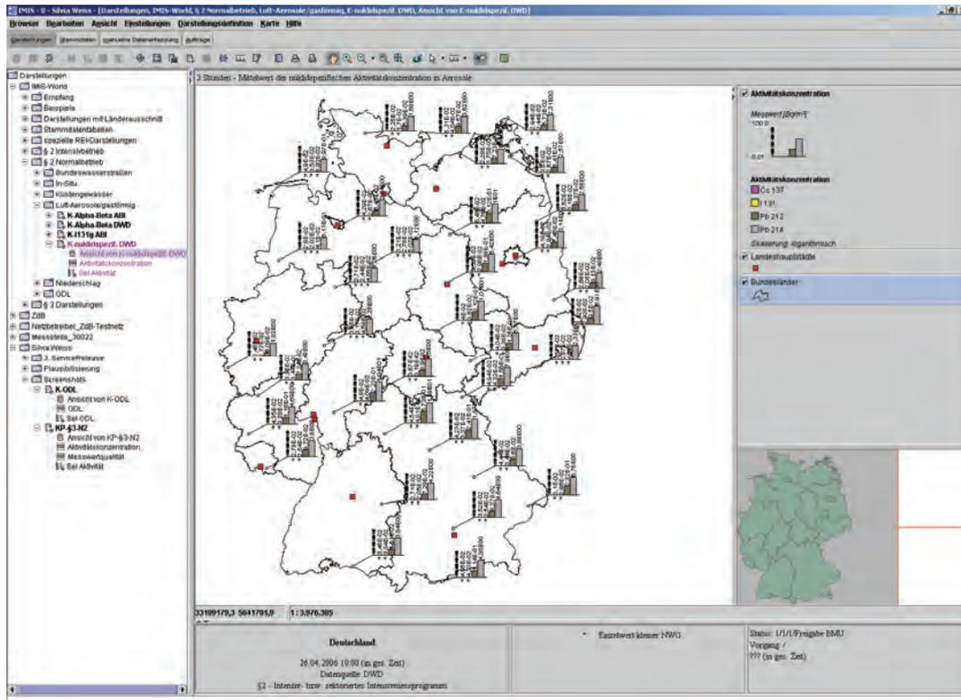
**Abbildung 1: 2-Stunden-Mittelwert der nuklid-spezifischen Aktivitätskonzentration in Aerosolen**
