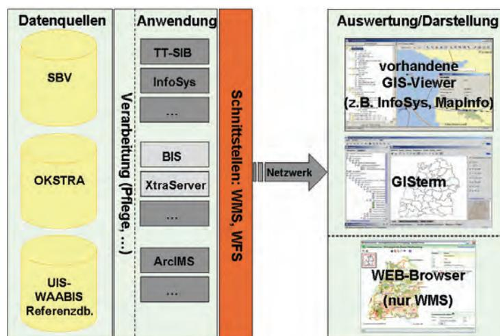
Abbildung 1: Nutzung offener WMS/WFS Schnittstellen für alle Anwendungen
