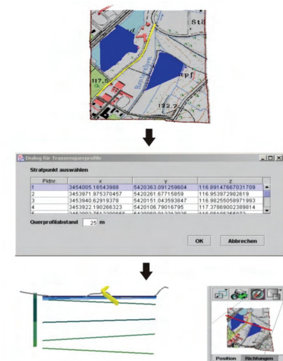
Abbildung 2.15: Erzeugung von Trassenquerprofilen
