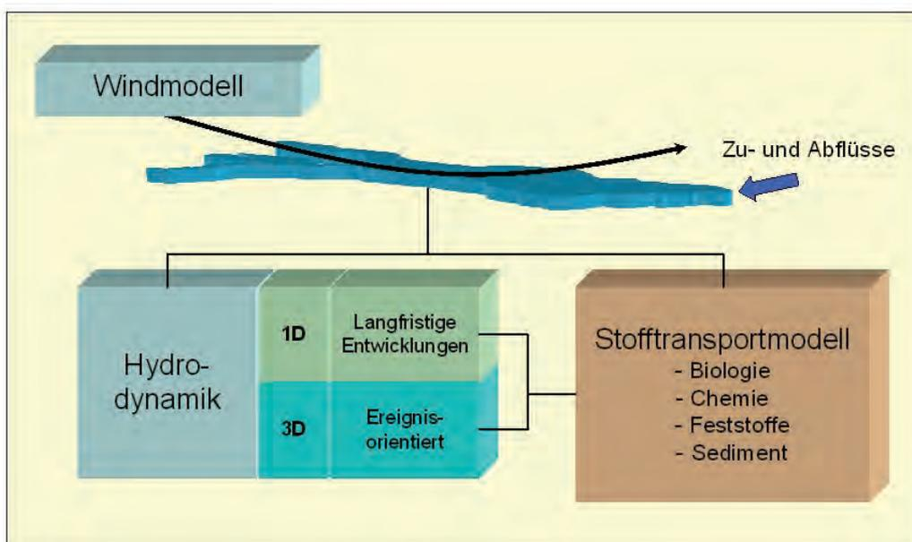
Abbildung 2.1: Schematische Darstellung der Modelle im Informationssystem
