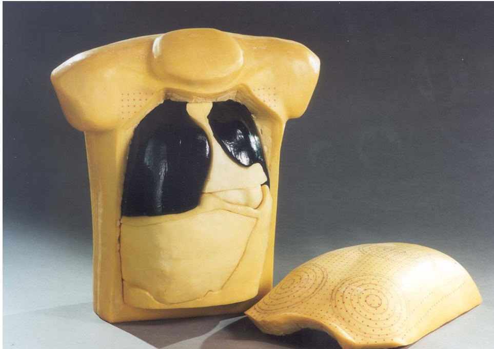
Abb. 2-6: Geöffnetes Torso-Phantom zur Kalibrierung der Teilkörperzähler von HS (Nachbau des LLNL-Phantoms; Hersteller Humanoid Systems Inc.)
