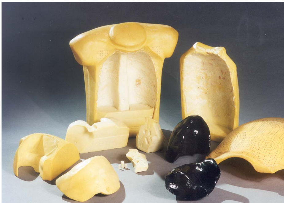
Abb. 2-7: Zerlegtes Torso-Phantom zur Kalibrierung der Teilkörperzähler von HS (Nachbau des LLNL-Phantoms; Hersteller Humanoid Systems Inc.)
