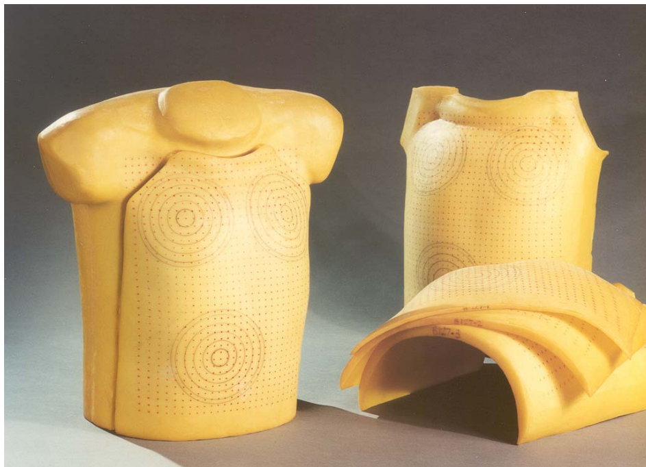
Abb. 2-5: Torso-Phantom zur Kalibrierung der Teilkörperzähler von HS (Nachbau des LLNL-Phantoms; Hersteller Humanoid Systems Inc.)
