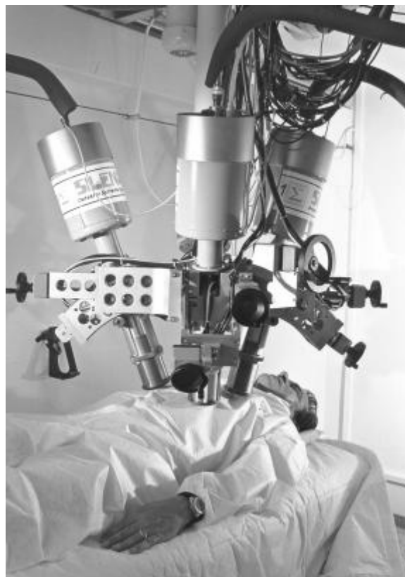
Abb. 2-2: HPGe-Sandwich-Detektoren des Karlsruher Teilkörperzählers in Lungenmessposition
