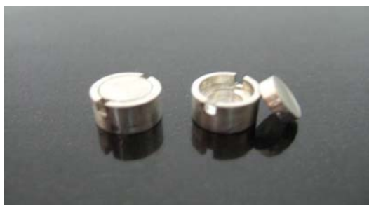
Abbildung 9: Verwendete Zinnkapseln als Energiekompensationsfilter
