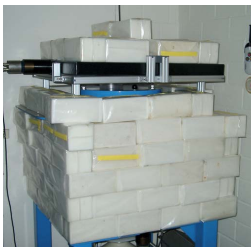
Abbildung 4: Messanordnung mit Paraffinblöcken
