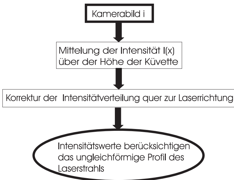
Abbildung 4.10: Korrektur der Kamerabilder bezüglich der Laserintensität
