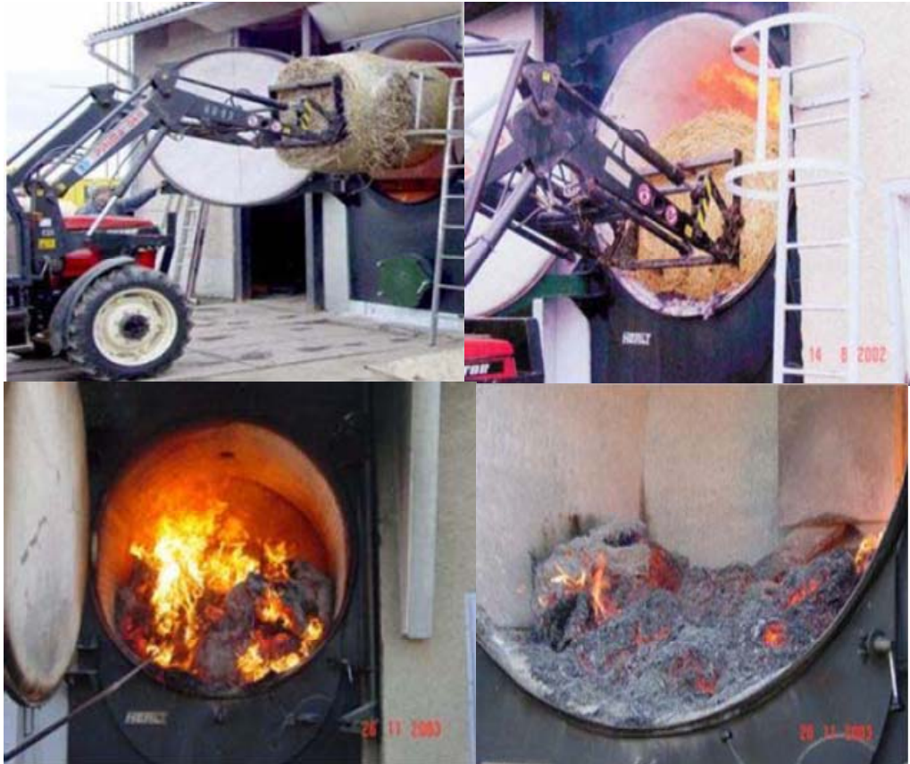
Abb. 22: Beschickung und Abbrand des Ganzballenvergasers
