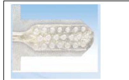
Fig. 27 Elektrodenarray bestehend aus 21 flachen Elektroden die auf die Oberfläche des Stammhirns aufgebracht werden. Quelle: Cochlear Ltd ( http://www.cochlear.com/ )
